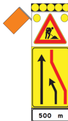
Figura 12: "segnale mobile di preavviso" fig. Il 400 Art.39 Reg. da impiegare su tratti autostradali con corsia di emergenza per la chiusura di una o più corsie di transito (la figura esemplifica la chiusura della corsia di marcia in dx). E' integrato con set di 6 lampade a led ad alta efficienza luminosa diam. 300 mm (con possibilità di lampeggio sincrono e sequenziale) e con sbandiatore elettromeccanico posto in alto sul lato esposto al traffico.
