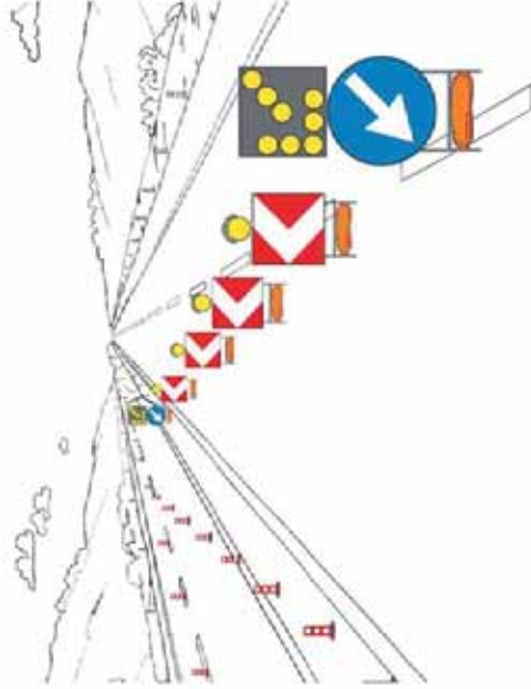
TESTATA DI SCAMBIO PER CANTIERE TRA 2 E 7 GIORNI
