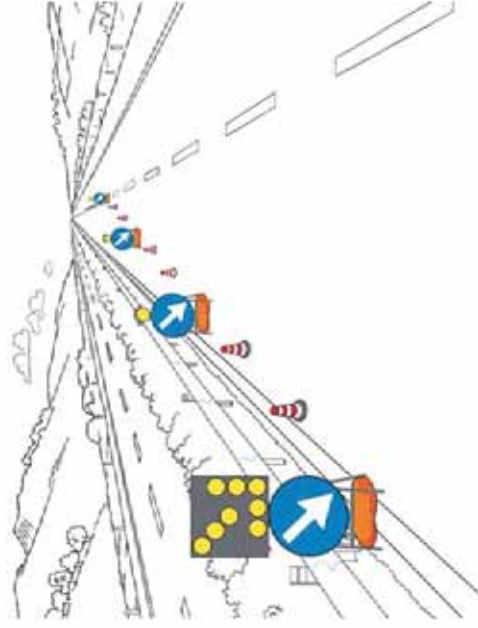
TESTATA DI RIDUZIONE PER CANTIERE INFERIORE A 2 GIORNI
